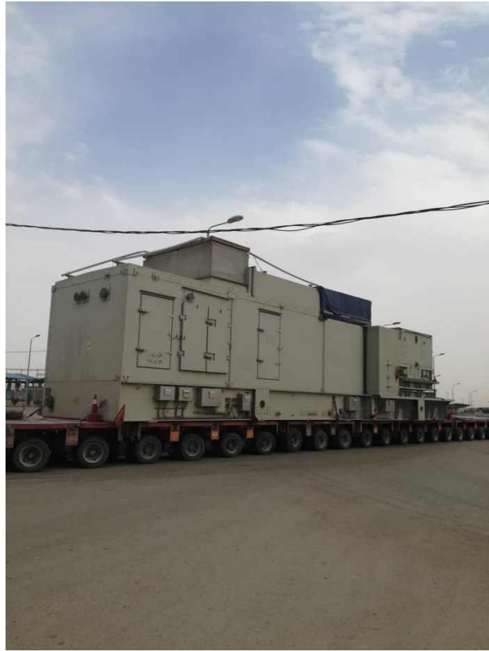
روز یکشنبه ۱۴۰۰/۰۳/۰۲ توربوژنراتور GTG4 بر روی پایه های موقت نصب گردید
